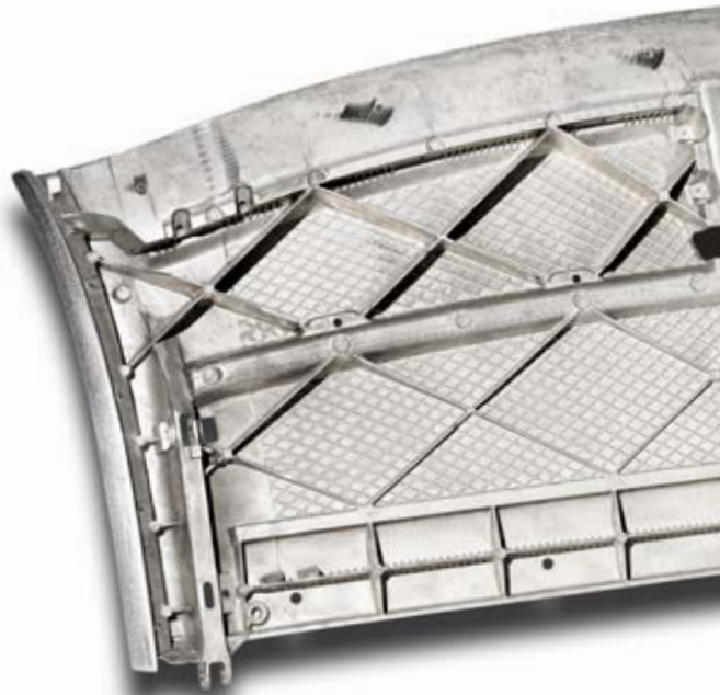
Cabrioletstomme. Gjuten lågviktsprodukt i magnesium. Bidrar till en lätt, säker och tyst taklösning till personbilar i premiumsegmentet.
